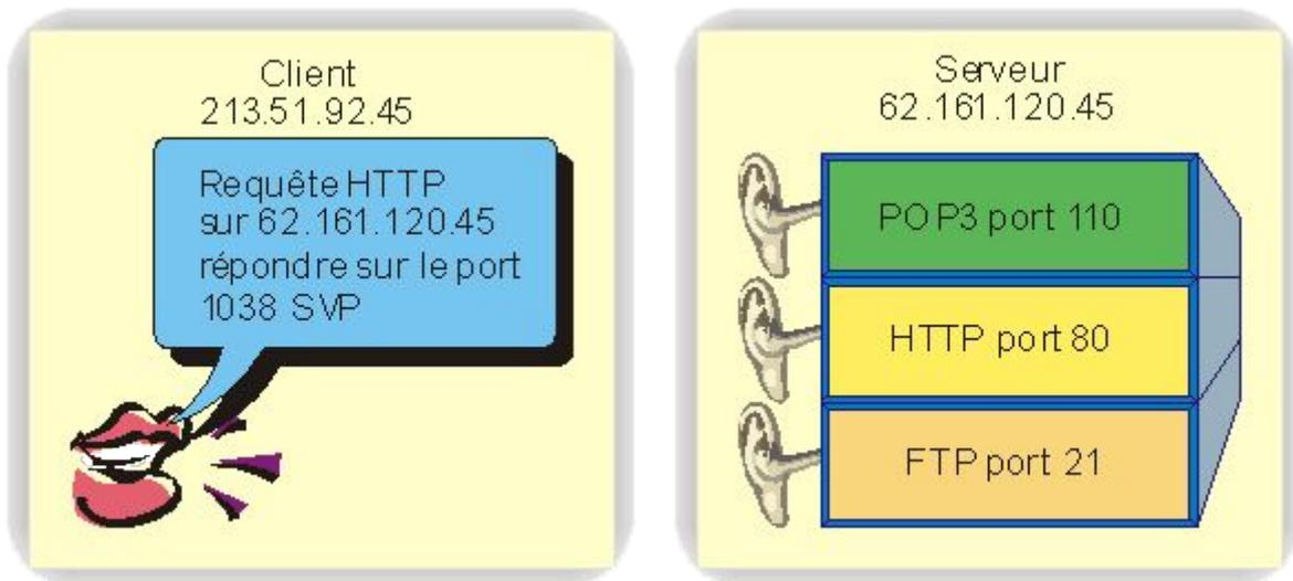
En revanche, le client qui émet la requête ne dispose pas de port d'écoute attribué. Ce n'est pas un serveur, c'est un client; il n'a donc rien à écouter d'autre que les réponses à ses questions. Il faut donc, lorsqu'il envoie sa requête, qu'il spécifie sur quel port il va écouter la réponse, de manière à ce que le serveur puisse construire un socket efficace pour ladite réponse.
