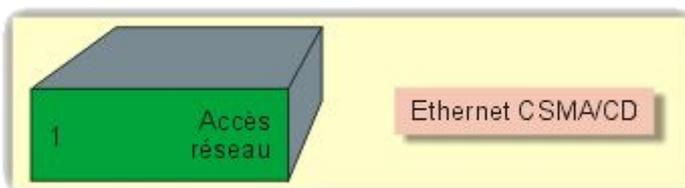
Protocole de plus bas niveau sur le réseau, il assure la bonne gestion du médium (détection de collisions) et permet l'acheminement des informations entre émetteur et destinataire au niveau des adresses MAC.
