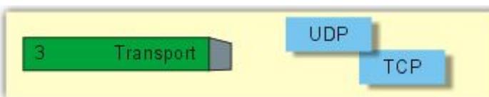
Ici, ce sont les protocoles orientés transport de données. UDP est dit "sans connexion" et TCP "est dit "avec connexion". Nous verrons plus loin ce que ceci veut dire.
