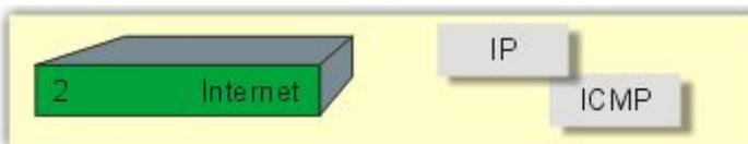
Ce sont ici des protocoles de haut niveau de la couche réseau. IP permet le routage des informations entre réseaux, c'est ici que l'adresse IP est utilisée.
