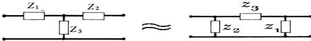
**Figure. II.9. Equivalence entre un filtre en  $\pi$  et un filtre en T [2].**
