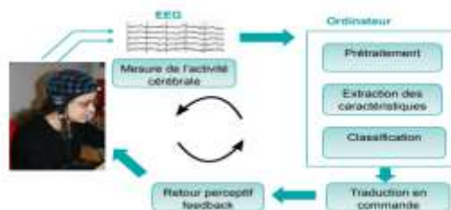
Figure 1 : Schéma général du fonctionnement d'une ICM.
